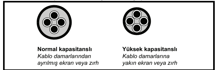
Şekil 6-8 Kapasitansı etkileyen kablo yapısı
